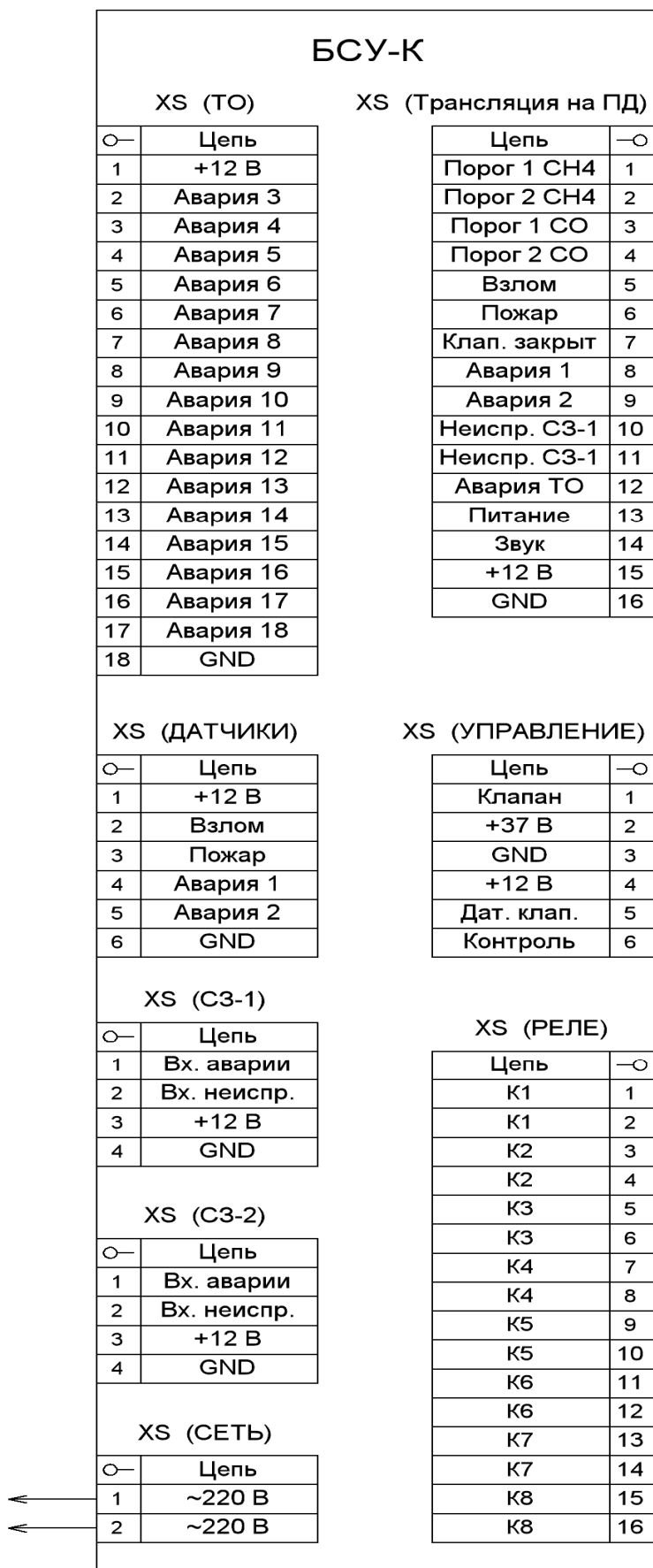
Рисунок Б.2 - БСУ-К. Схема электрическая соединений.
