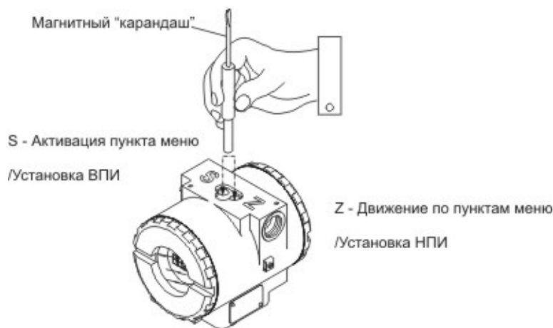
Рис. 8 – Расположение элементов локальной настройки.
